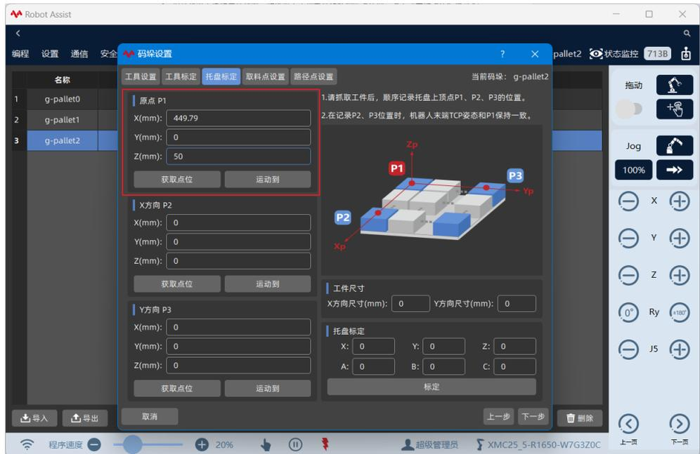
3. 保持机器人抓取产品状态，将机器人末端工具移动到 X 方向顶点位置，点击“获取点位”记录 P2 点位置，P2 点位置的 X, Y, Z 将被显示，可手动调整该位置。当机器人不在 P2 点时，点击“运动到”回到 P2 位置。
