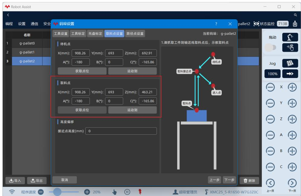
输入接近点高度值，程序会自动算出取料接近点的位置（基于取料点做高度上的偏移）
