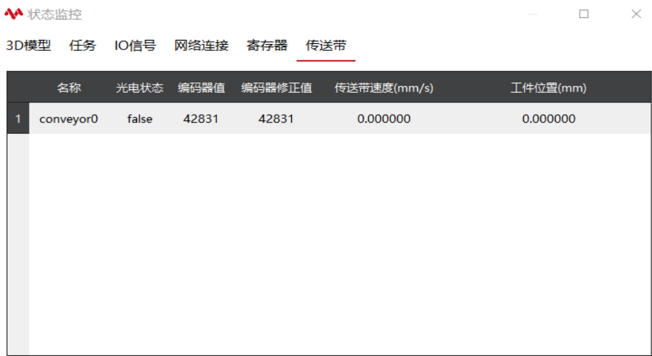
图 12 查看光电开关状态
