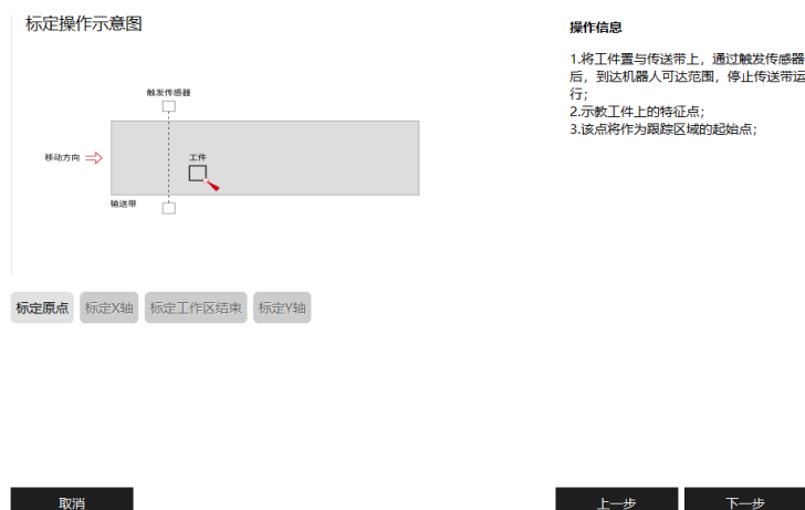
图 14 标定传送带坐标系
