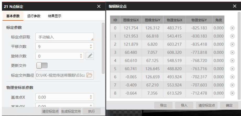
图 22 九点标定编辑标定点
