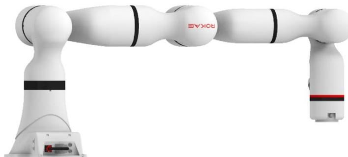
当机器人处于这种位姿时，机器人沿平行于 3 轴或 5 轴方向的运动受到限制。在机器人运动到工作空间边界位置时，通常会导致机器人处于这种奇异状态。
