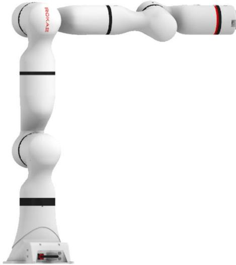
此时，机器人求解逆解时，无法区分 5 轴与 7 轴角度。
