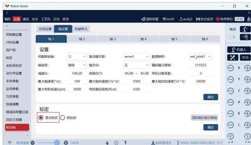
图 11 附加轴零点标定
